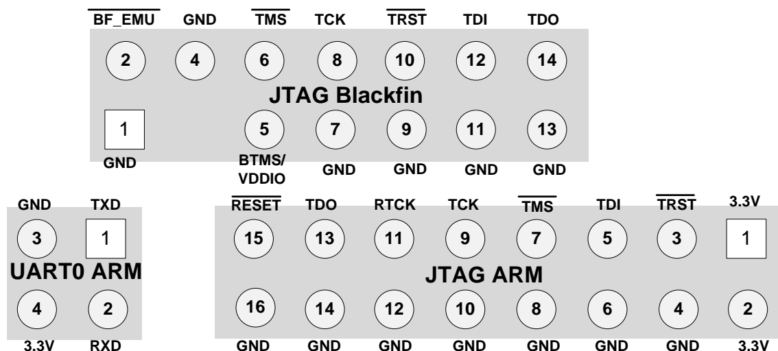
Рис. 4-15. Детализация сигналов на разъемах JTAG Blackfin JTAG ARM и UART0 в LPC43x
