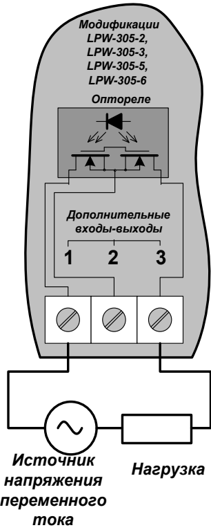
Рисунок Б.13 – Подключение импульсного выхода оптореле LPW-305 с креплением на DIN-рейке к цепи переменного тока
