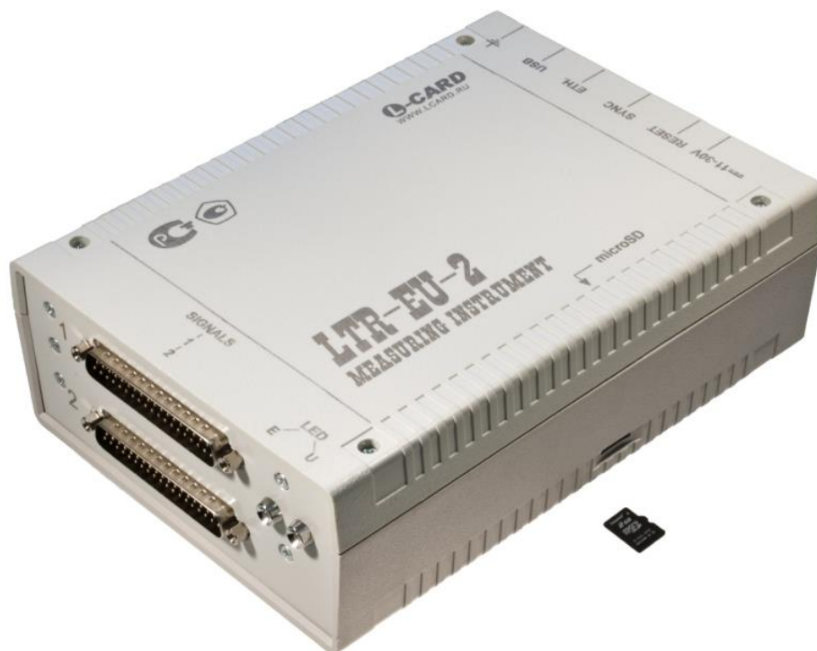
Рис. 4-9. Крейт LTR-EU-2 (Board_Version = 1) с возможностью установки Micro-SD карты памяти
