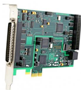
Рисунок 5 – Внешний вид преобразователей модификации L-502 (пломбирование не предусмотрено)
